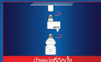
เลือกพื้นที่ต้องการ เปิด-ปิดไฟอัตโนมัติโดยไม่ต้อง เปิด-ปิดสวิตช์ ติดตั้งเซ็นเซอร์เข้ากับหลอดไฟและแผงวงจร
