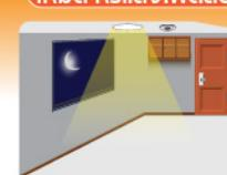
เมื่อตรวจสอบการเคลื่อนไหว ในระยะ 8m. หลอดไฟจะสว่างขึ้น หากไม่ได้ตรวจสอบการเคลื่อนไหวหรือ
