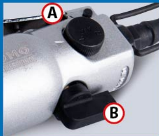
A : บริเวณปรับความเร็วลม มีอยู่ 3 ระดับ 1-3 The wind speed adjust is 3 levels 1-3 B : ปรับทิศทางการหมุนของ ไขควงลม Adjust the direction of rotation of the wind screwdriver
