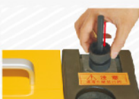
3 ลับมุมหลบ Grind the lip relief angle
