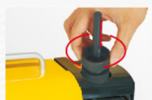
4 ลับมุมคมตัด Grind the front cutting lip
